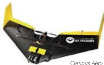
Campus Aéro : fabrication d'un drone aile volante
